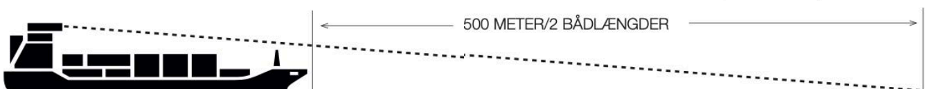
UDSIGT FRA SKIBSBROEN Grafikken viser, at det blinde område foran stævnen på et stort skib kan strække sig mange hundrede meter ud på vandet.
